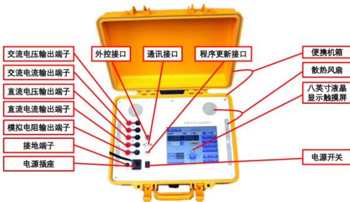
图 5.1 SLD07105 面板结构图
